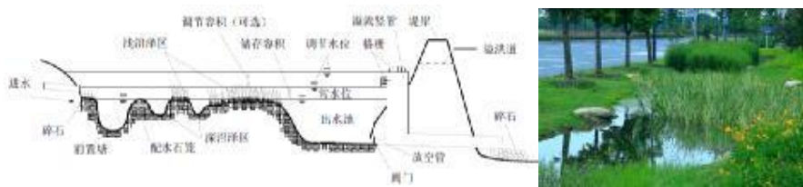
图6-16 雨水湿地典型构造示意图及实景图
