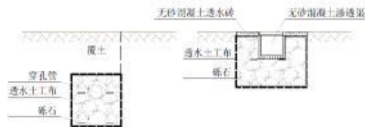
图6-20 渗管/渠典型构造示意图
