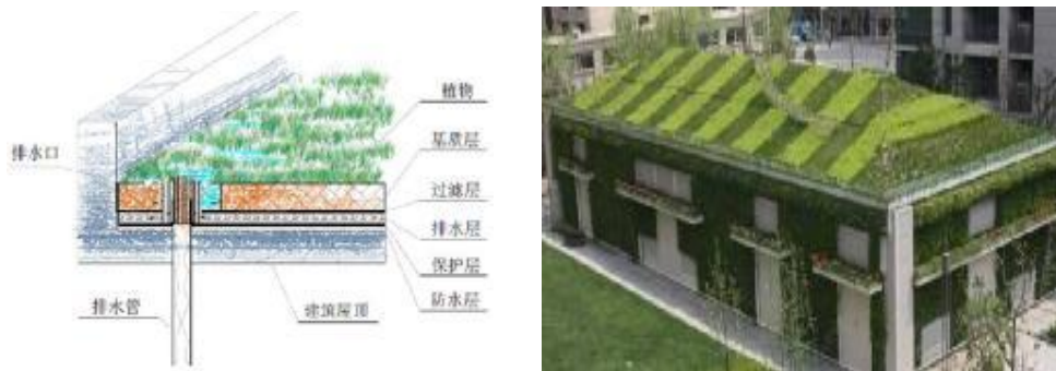
图6-10 绿色屋顶典型构造示意图及实景图
